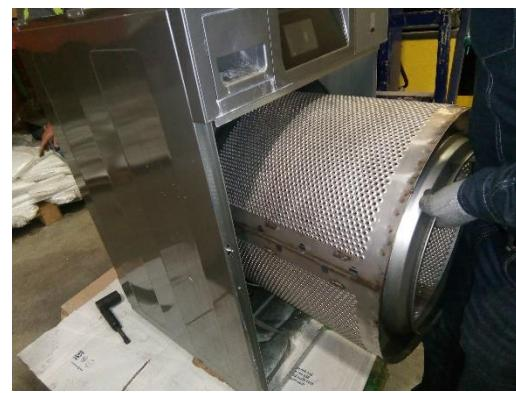
**Paso 8:** Meter el eje del tambor con apriete hasta que haga tope para que el eje y rodamientos queden alineados. Para ello utilizar una bomba hidráulica o similares.
