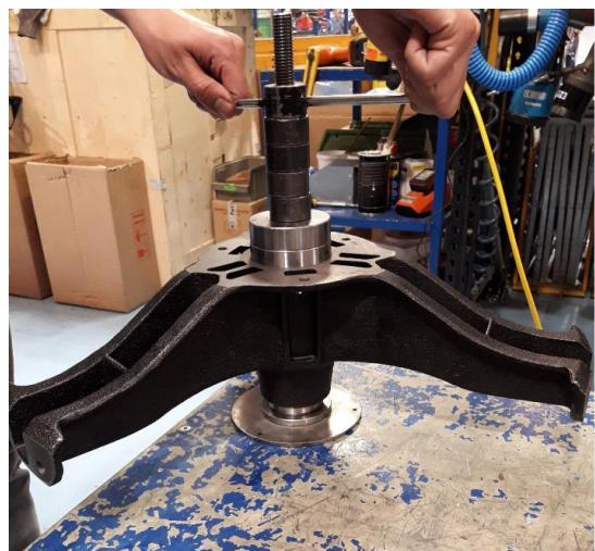
**Étape 8 :** Serrer l'axe du tambour jusqu'à la butée pour que l'axe et les roulements soient alignés. Pour ce faire, utiliser une pompe hydraulique ou similaire.
