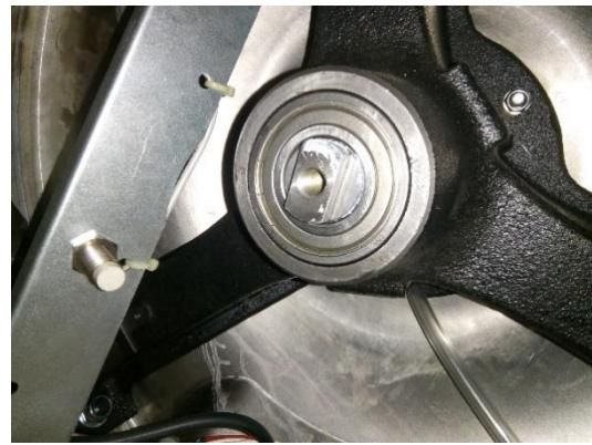
**Étape 9 :** Remonter la poulie, le support du capteur et les panneaux.
