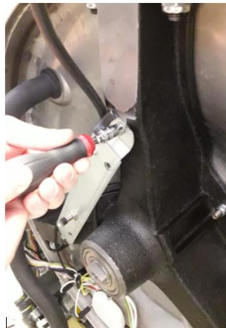
**Étape 3:** Retirer la porte, le fonds de porte et le loquet. Le loquet n'a pas besoin d'être complètement enlevé, desserrer les deux vis indiquées sur l'image et le déplacer sur le côté suffit.
