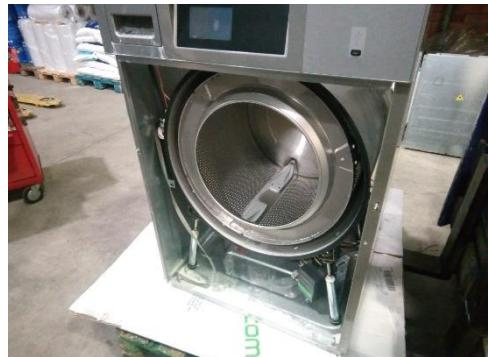
**Étape 6 :** Détacher le tambour à l'aide d'un extracteur. Il est important que vous placiez une vis pour que l'extracteur puisse être appuyé sans endommager le filetage.
