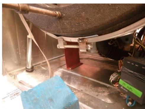
**Paso 10:** Apretar el tornillo de la polea y los del sensor de movimiento para fijarlos.
