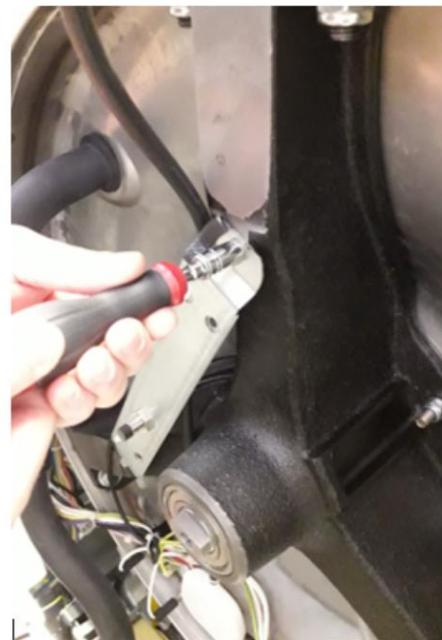
**Étape 2 :** Séparer le conduit de trop-plein et le pressostat pour faciliter le retrait du support des roulements.
