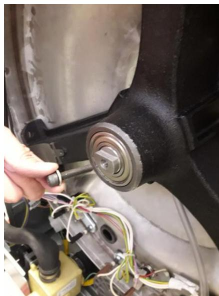
**Paso 5:** Extraer el soporte rodamientos con la ayuda de un extractor.
