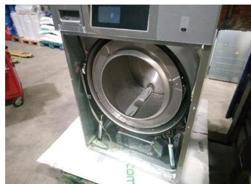
**Paso 6:** Soltar el tambor con la ayuda de un extractor. Importante colocar un tornillo para que el extractor se apoye sin dañar la rosca.
