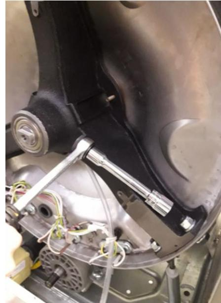
**Paso 4:** Colocar un tornillo de seguridad para proteger la rosca del eje.
