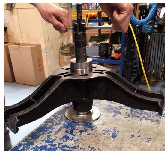
**Paso 8:** Meter el eje del tambor con apriete hasta que haga tope para que el eje y rodamientos queden alineados. Para ello utilizar una bomba hidráulica o similares.
