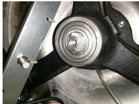
**Paso 9:** Posicionar el frente cuba y el contrapeso con ayuda de dos sargentos y volver a apretar el aro que los sujeta. Importante colocar correctamente el contrapeso para que el fondo puerta quede centrado.
