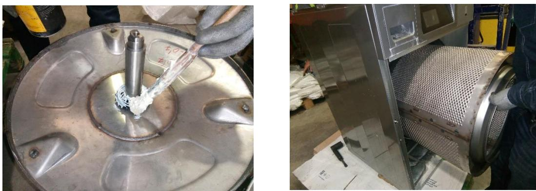
**Étape 8 :** Serrer l'axe du tambour jusqu'à la butée pour que l'axe et les roulements soient alignés. Pour ce faire, utiliser une pompe hydraulique ou similaire.
