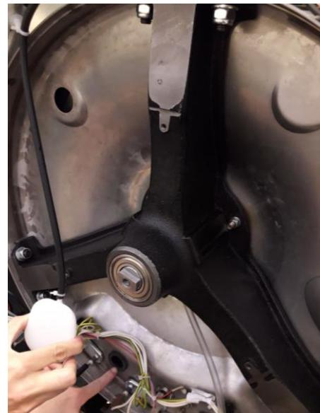
**Paso 3:** Soltar los tres tornillos del soporte rodamientos y los seis de la cruceta.
