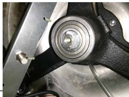
**Paso 9:** Volver a montar la polea, soporte sensor y los paneles.
