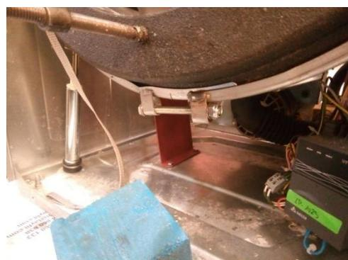
**Étape 10:** Serrer la vis de la poulie et celles du capteur de mouvement pour les fixer.
